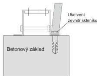
V základnách jsou připravené otvory k ukotvení skleníku. Doporučujeme použít natloukací hmoždinky pr. 8x60mm
