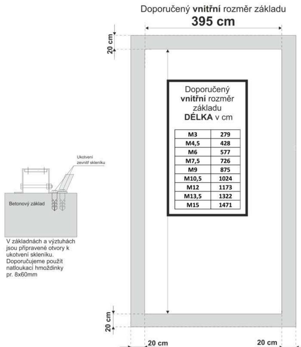
Doporučujeme pevné betonové základy ( lze použít i ztracené bednění). Pouze v případě řádného ukotvení skleníku k pevným základům lze dát plnou garanci za stabilitu skleníku dle statických výpočtů.
