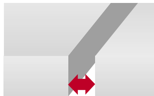
Při tmelení spár je nezbytně nutné, aby šířka spáry byla min. polovina tloušťky desky
